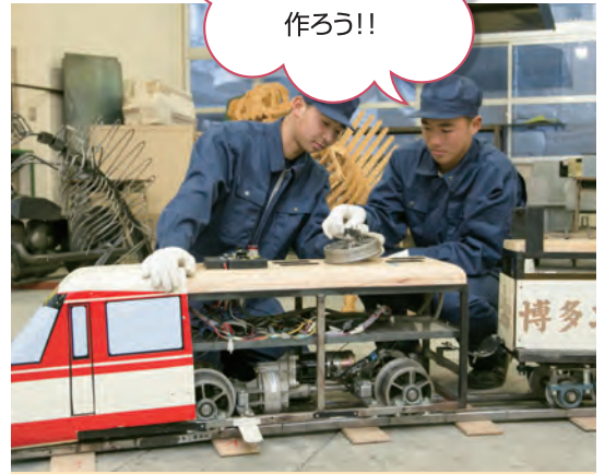
溶接・旋盤・MC・3DCAD 技術により3年間で製作
