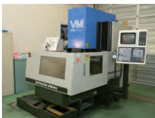
MC工作機械 プログラムにより自動で機械工作
