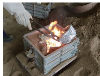
鋳造 溶かしたアルミニウムを流し込み表札を製作
